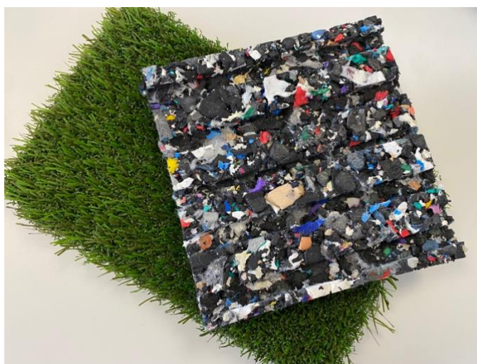
La couche de souplesse et le revêtement en synthétique du terrain de football synthétique UBO
